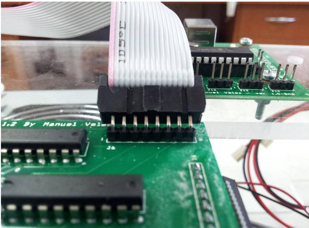
El conector central del cable se conecta al conector J6 de la display 2 usando la fila de agujeros pares del conector:
