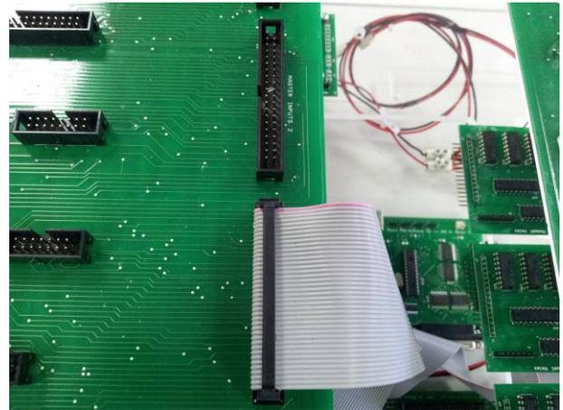
Ya sólo queda conectar los módulos IDC a la tarjeta PCB Pedestal cada uno a su propio conector.
